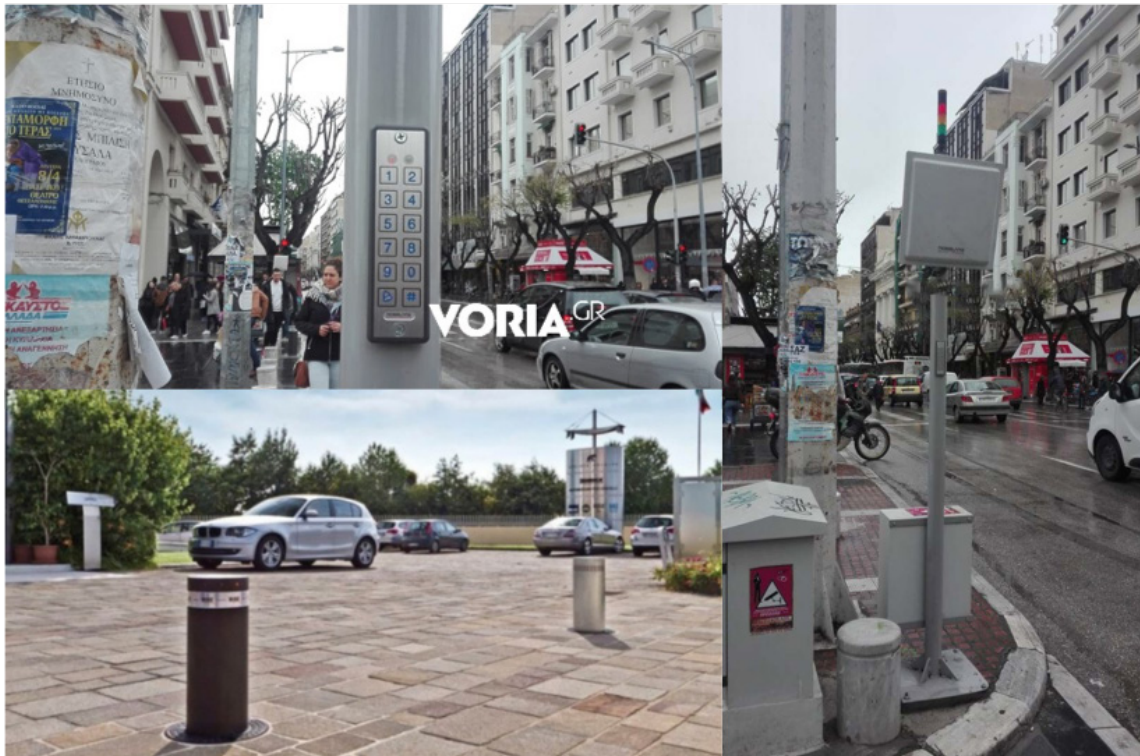
Σχήμα 9.27: Διατάξεις ελεγχόμενης πρόσβασης σε οχήματα διανομής σε πεζοδρομημένες οδούς και οδούς ήπιας κυκλοφορίας
